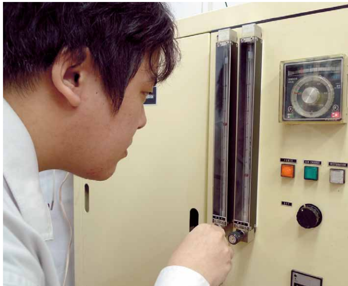
※標準器の既知の値と計測器の示す値との差を測定する校正作業風景
